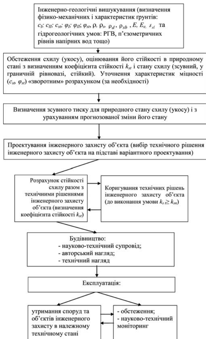
Рисунок В.1 – Основні етапи проектування, будівництва та експлуатації споруд та об'єктів інженерного захисту
