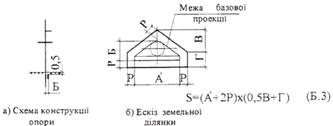
Рисунок Б.3 - Стояк одиночний з круглим перерізом з ригельним закріпленням у ґрунті при довжині ригеля понад 1 м
