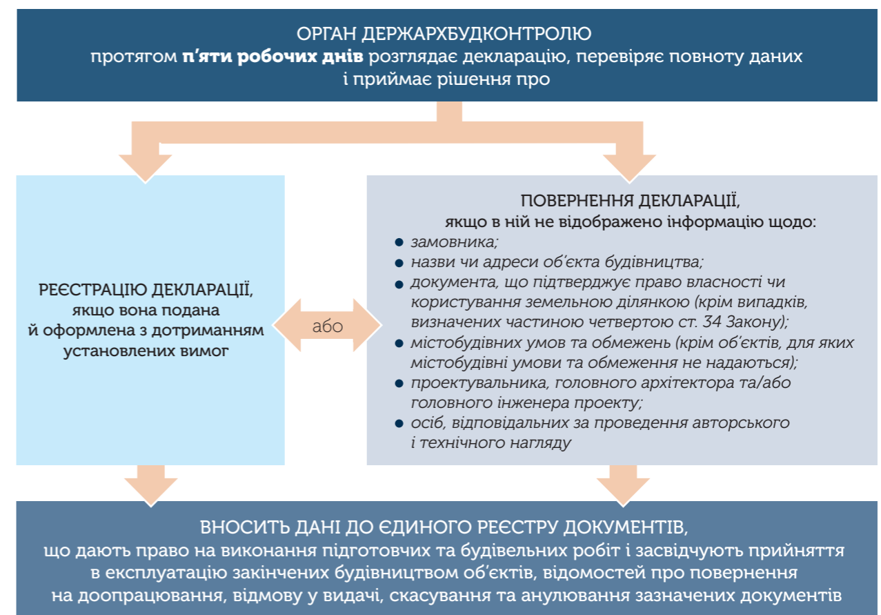
Рис. 4. Реєстрація декларації про початок виконання будівельних робіт
